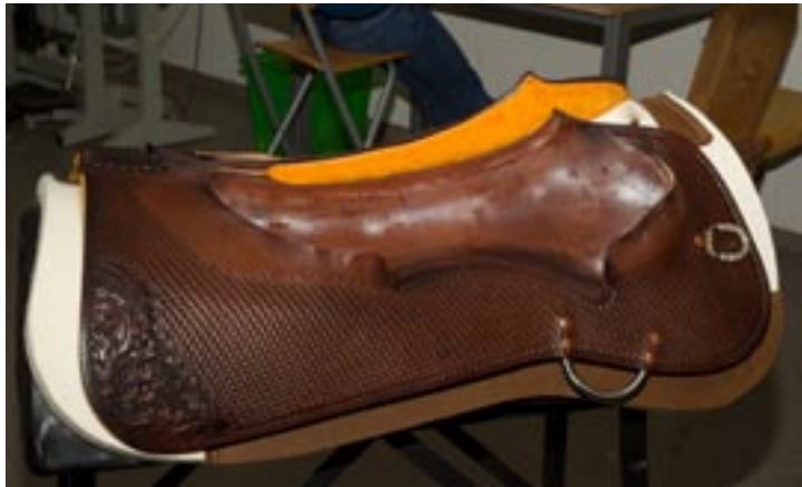
DAS FÜR DEN SATTELBAUMAUSTAUSCH VORBEREITETE „BETT“.
